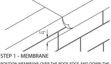
POSITION MEMBRANE OVER THE ROOF EDGE AND DOWN THE OUTSIDE FACE OF THE WALL, OVERLAPPING THE NAILER(S) BY AT LEAST 1/2".
