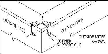
STEP 1 - CORNER SUPPORT CLIPS LOCATE AND FASTEN THRU GALVANIZED CORNER SUPPORT CLIP TO THE WALL AS SHOWN. FOR FASTENER DETAIL SEE PAGE 4.
